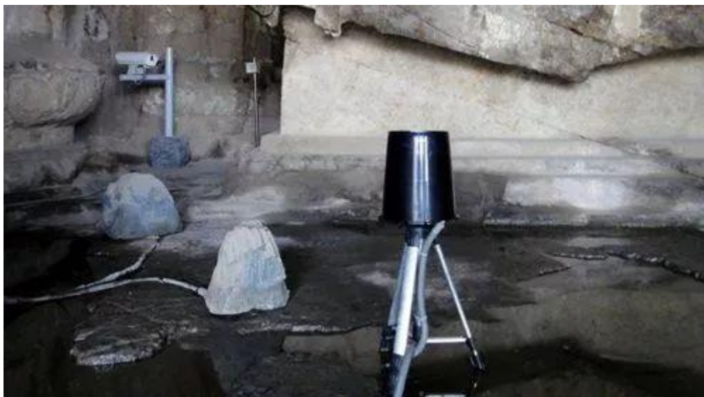
图 1-3-1 - 洞窟内的红外相机和渗漏水收集仪器
